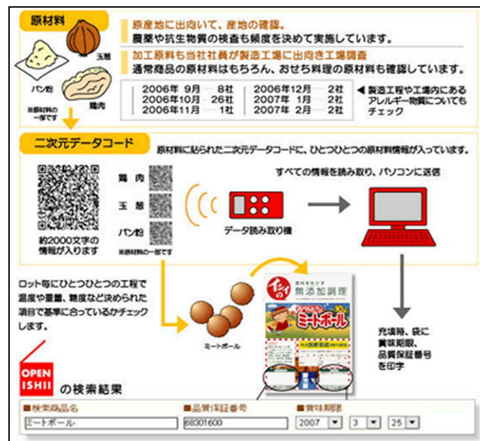
図表 2 製品ひとつひとつの原材料がわかる仕組み（出所：石井食品㈱の HP より）
